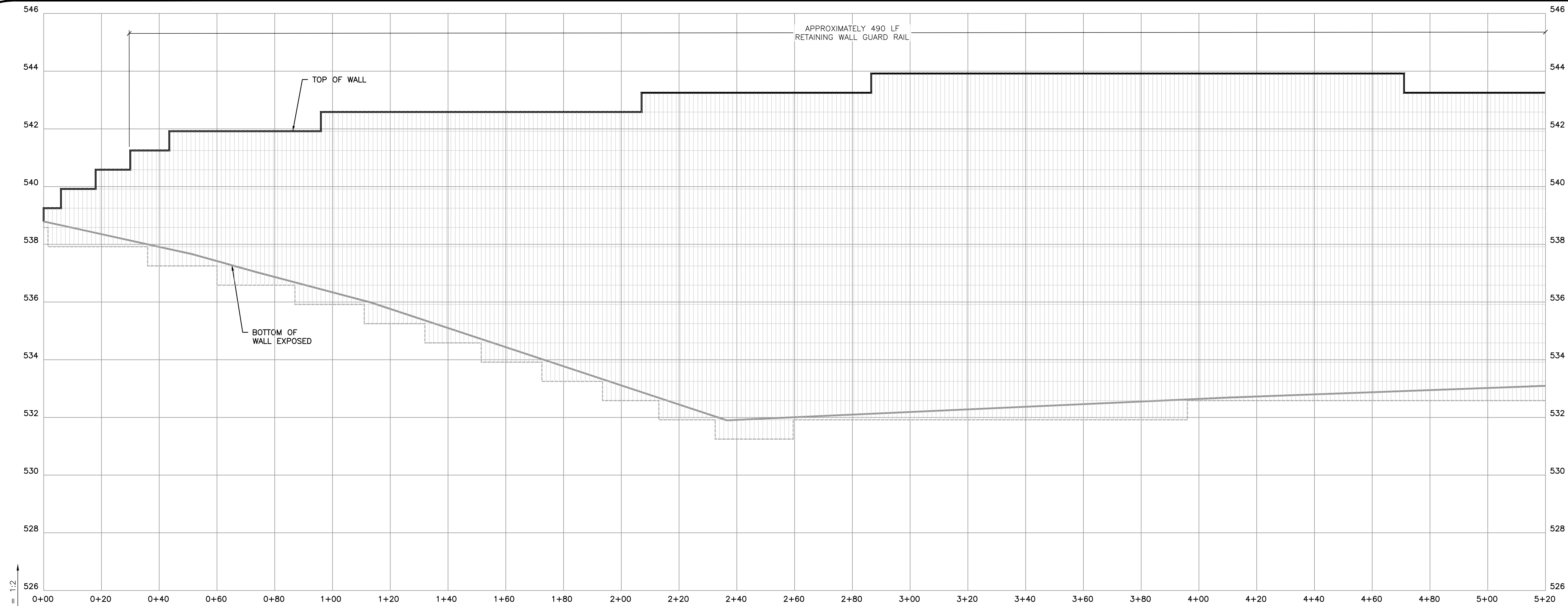
RETAINING WALL B (STA 0+00 - STA 5+20) SCALE: 1" = 20'
